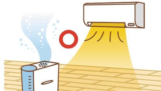
エアコン、暖房等を長時間連続して使用すると室内が過乾燥になる場合があります。乾燥のし過ぎによりフロアの継ぎ目にすき間ができた、表面にクラック(ひび割れ)を生じたりすることがあります。加湿器等で適度な湿気(約45~70%)を捕うようにしてください。
